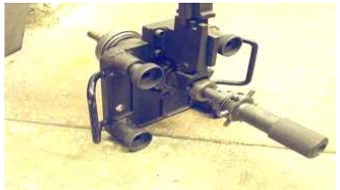
Рисунок 66 – Контрольное приспособление 24-Ф-3370 проверки чистоты выключения сцепления
