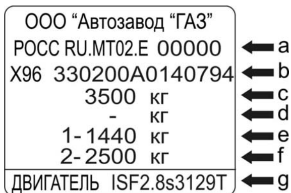
Рис. 1.3. Пример заводской таблички с паспортными данными, где:
